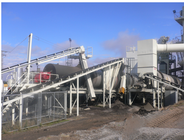
1. Instalación asfáltica de tipo discontinuo con tambor secador independiente para el material fresado.
