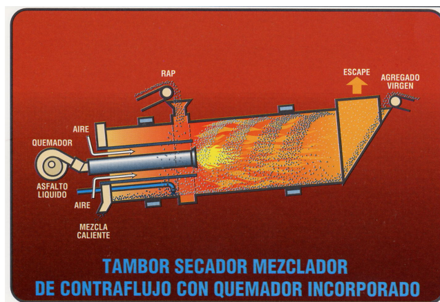
Figura 4 – Esquema de tambor secador mezclador de contraflujo con quemador central.
