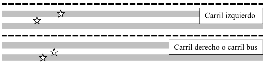
Figura 5. Situación de la extracción de los testigos en los distintos carriles.
