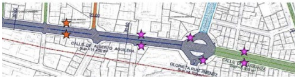
Figura 4 Localización de los puntos de extracción de testigos.
